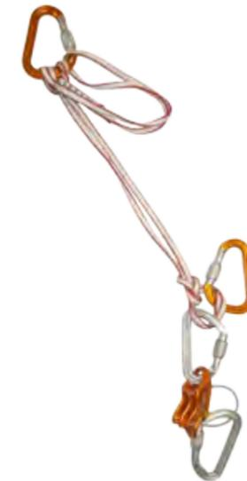
Figure 7: relais deux points avec point central fixe
