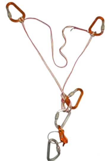
Figure 8: relais 3 points avec point central fixe
