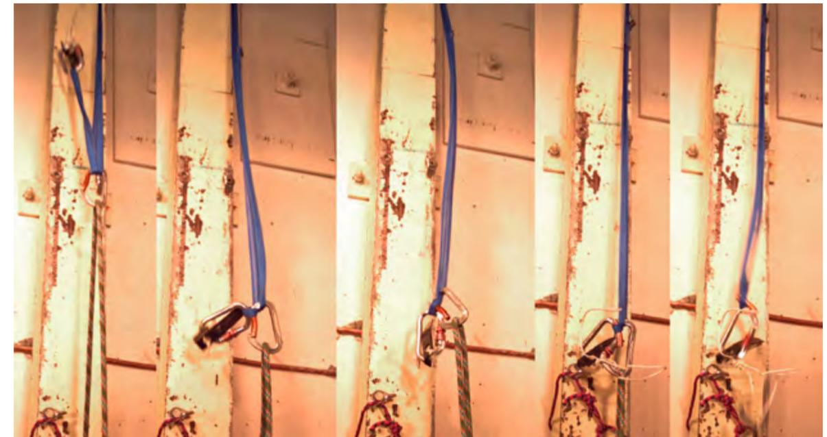
Figure 31: Simulation d'arrachement d'un piton lors d'une chute sur un couplage avec une sangle twistée.
