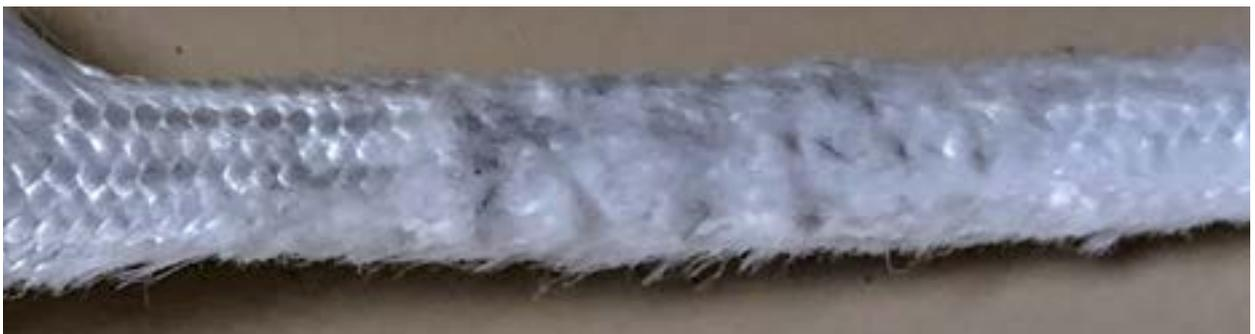
Figure 6 : la gaine montre de nombreuses marques d'abrasion sous la rupture.
