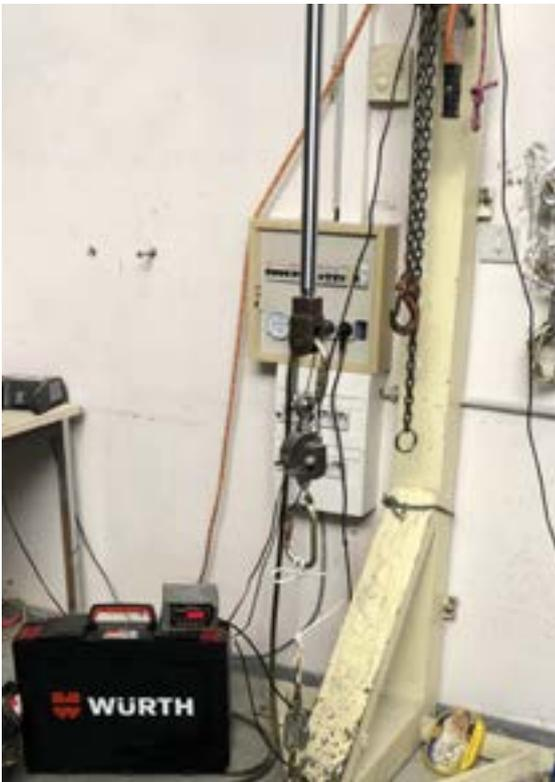
Figure 7 : mesures de résistance statique de la cordelette pure dyneema avec demi cabestan et nœud de mule.
