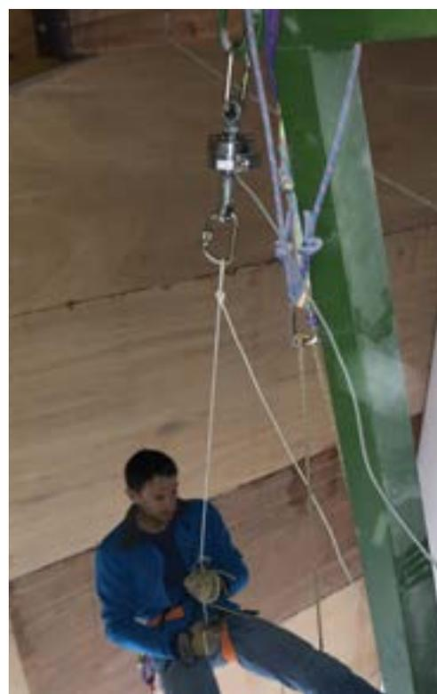
Figure 8 : protocole de mesure des forces générées en rappel : un dynamomètre est fixé sur le point d'ancrage
