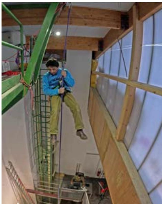
Figure 3 : descente en rappel en fil d'araignée à la tour d'essais du laboratoire de l'ENSA. Le rappel est installé sur le dynamomètre.
