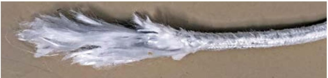
Figure 5 : rupture de la cordelette pure dyneema 2 mètres sous le point de fixation du rappel.
