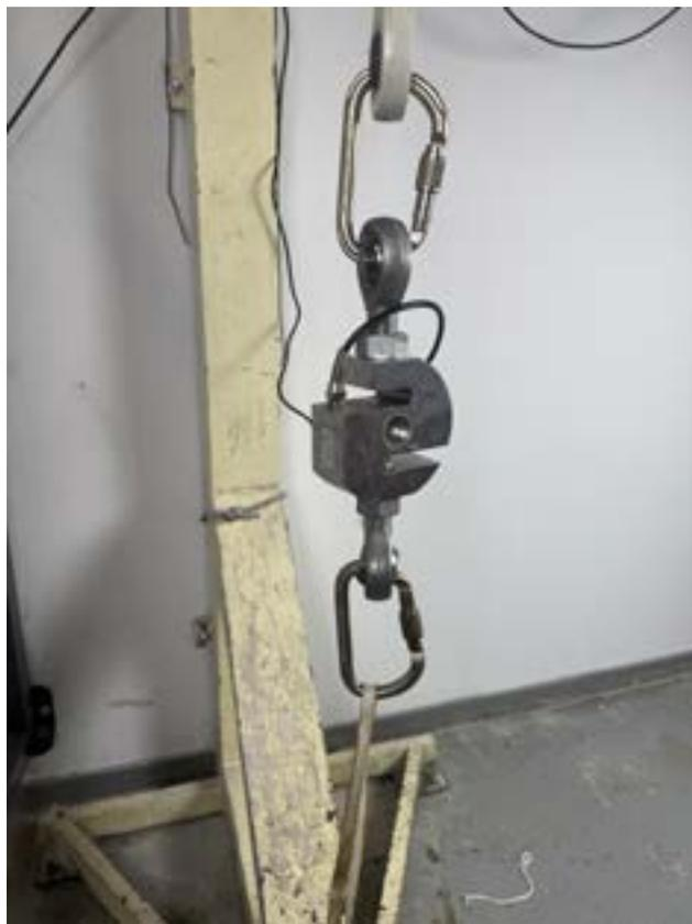
Figure 2 : dynamomètre SCAIME : fréquence d'acquisition 500Hz.
