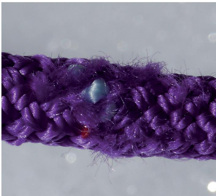
déchirure de la gaine d'une corde jumelée (ice twin) lors d'une chute en crevasse avec un encordement sur tibloc.
