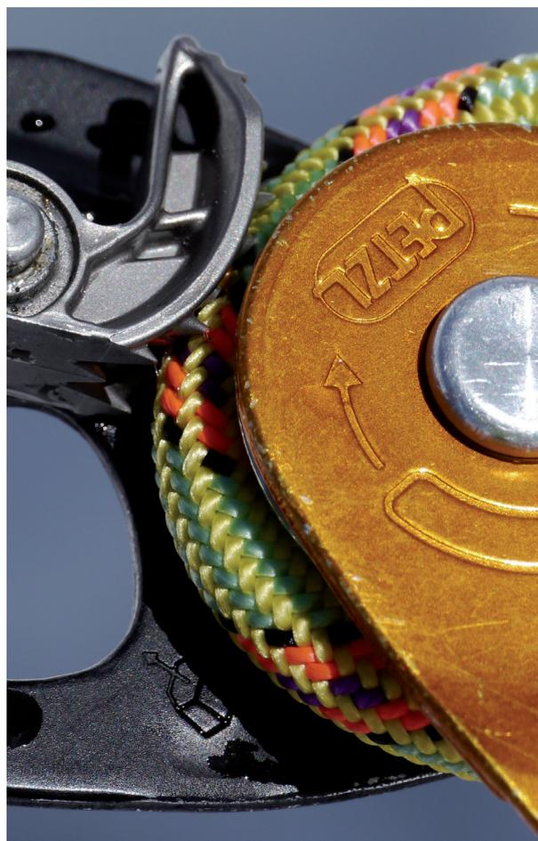
Chute en crevasse avec un encordement sur microtraxion™ de Petzl, les picots ont traversé la gaine.
