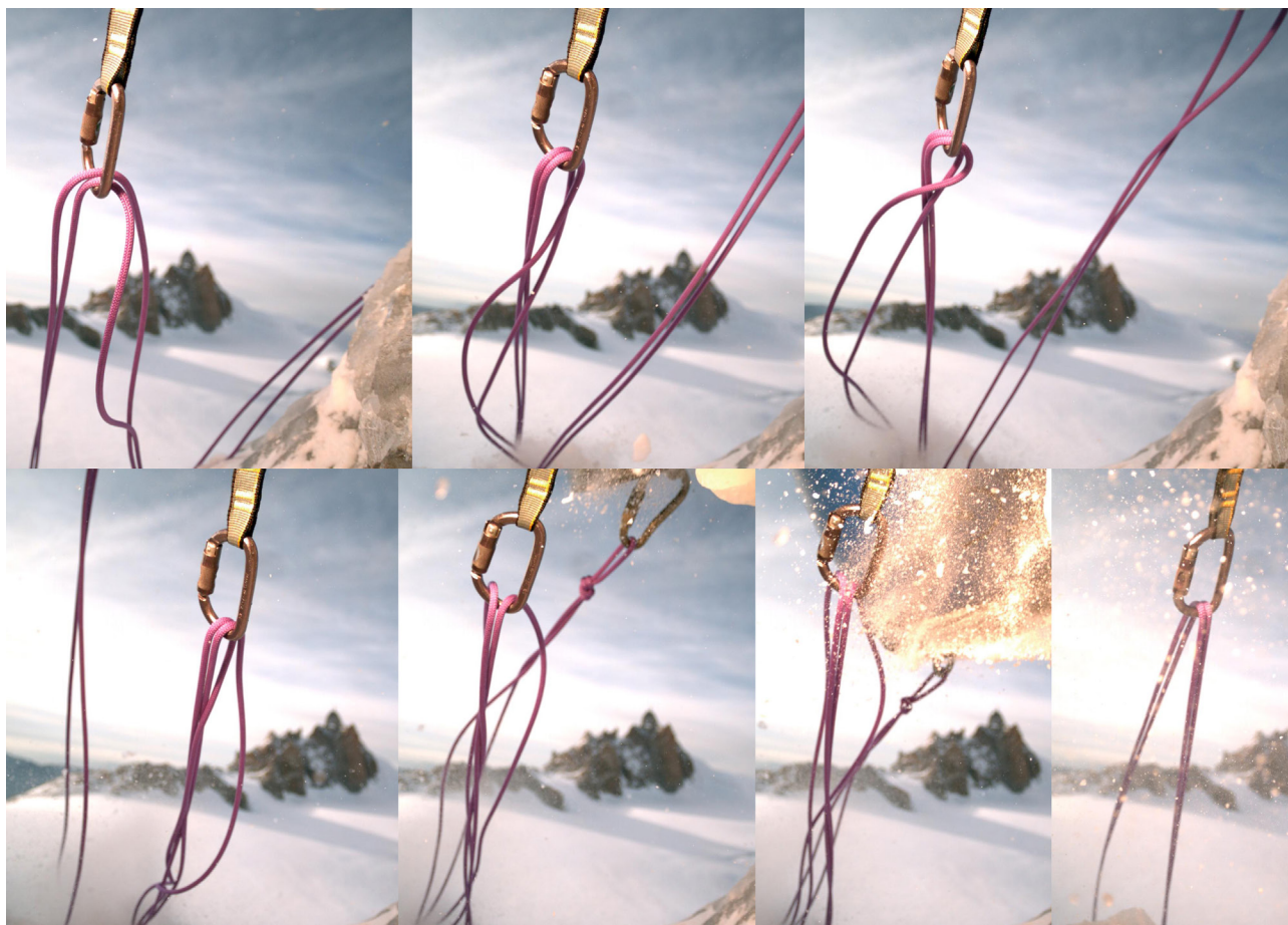
Boucles de mou de la corde jumelée et mouvements du mousquetons.
