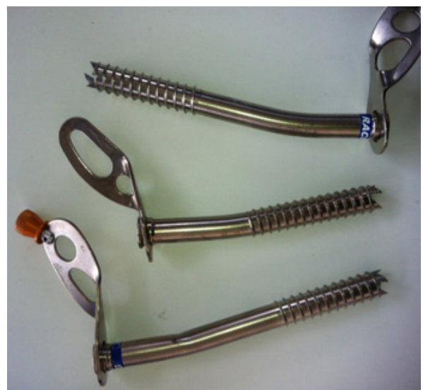
l'état des broches après les chutes montre la violence des chutes simultanées
