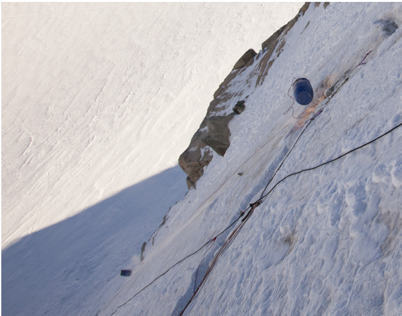
Largage simultané de deux masses de 80 kg simulant la chute de deux alpinistes dans la face nord de la pointe Lachenal
