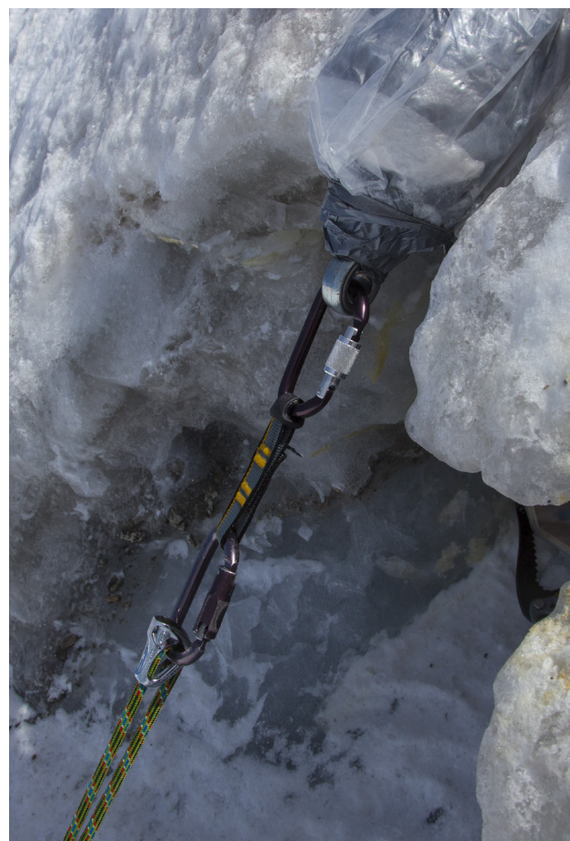
tibloc et corde intacte après la chute du leader
