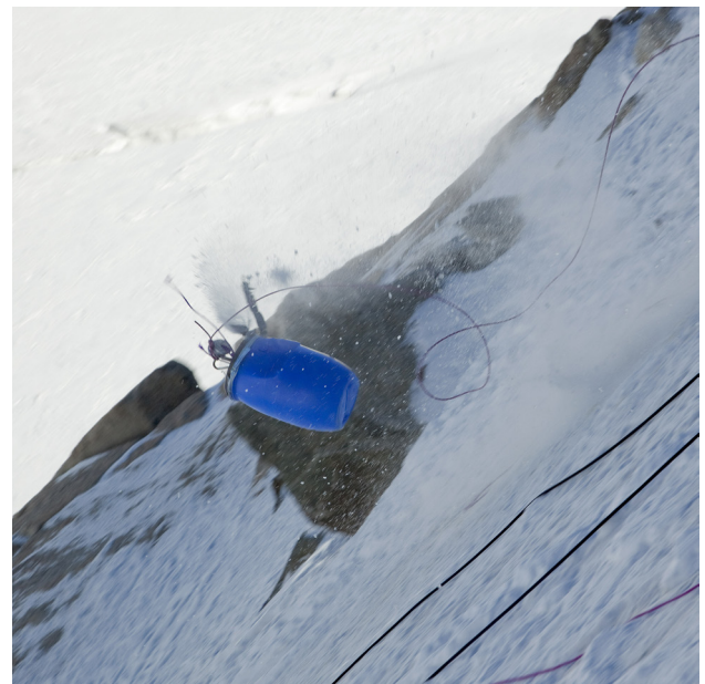
Violents rebonds de la masse amont lors de la chute ; on voit clairement le « mou » sur la corde d'assurage.
