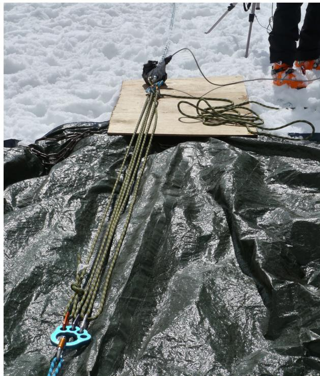
système de glissement à résistance constante permettant de simuler l'entraînement de la personne en surface lors d'une chute en crevasse.
