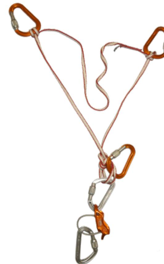
Figure 8: construction du relais avec trois points d'ancrage
